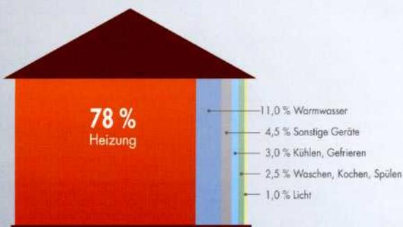
Mit einer Modernisierung oder dem Einbau einer neuen Heizung lassen sich die meisten Energiekosten sparen. Die Investition amortisiert sich schon bald.
