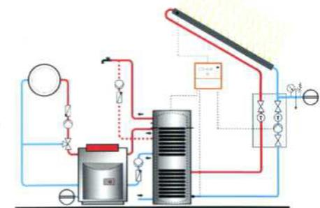
**Ein starkes umweltschonendes Energiespar-Trio: Sonnenkollektoren, Solarspeicher zur Brauchwassererwärmung und moderner Heizkessel.**
